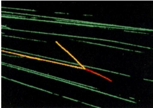
Colisión entre partícula *alfa* y núcleo de átomo de Sodio
